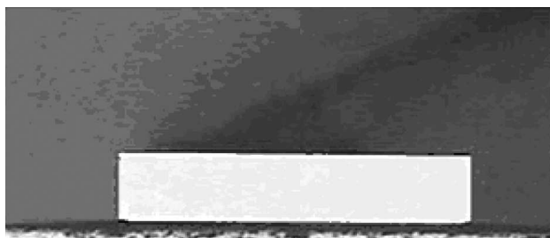
Рис. 1: Микрофотография выходного зеркала, собранного без термокомпенсатора лазерного диода.
