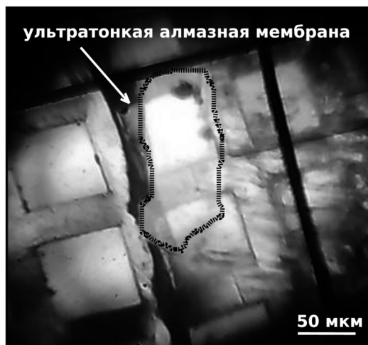
Рис. 1: Медная сетка с расположенными на ней тонкими алмазными пленками. Изображение получено в просвечивающем электронном микроскопе. Границы пленки, свободной от фиксирующего клея, обозначены черным контуром.
