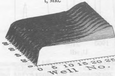
Рис. 6. Рассчитанные токовый отклик при включении смещения и зависимость от времени профиля распределения электрического поля вдоль оси структуры для сверхрешеток GaAs/Al 0.3 Ga 0.7 As ( d_W = 250 \text{ \AA} , d_B = 100 \text{ \AA} , 30 периодов) с различным уровнем легирования.
