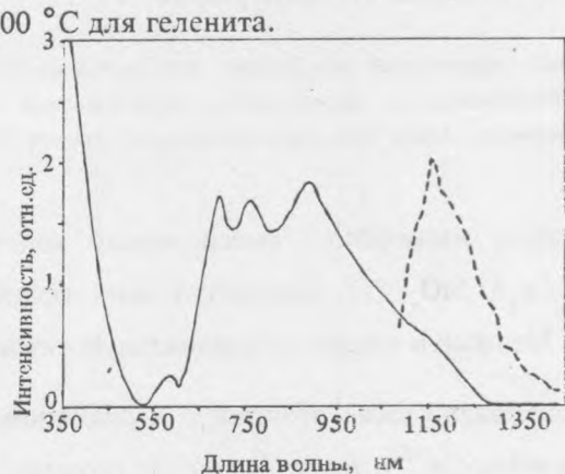
Рис. 1. Спектр поглощения ионов хрома в кристалле \text{Ca}_2\text{SiAl}_2\text{O}_7:\text{Cr} (сплошная линия) и спектр люминесценции ионов хрома (пунктирная линия).
