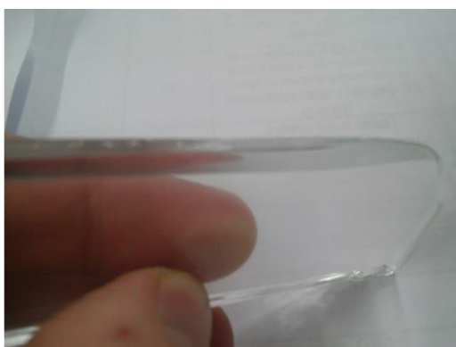
Рис. 11: Притуплённый торец, полученный методом многократного прохождения лазерного луча.
