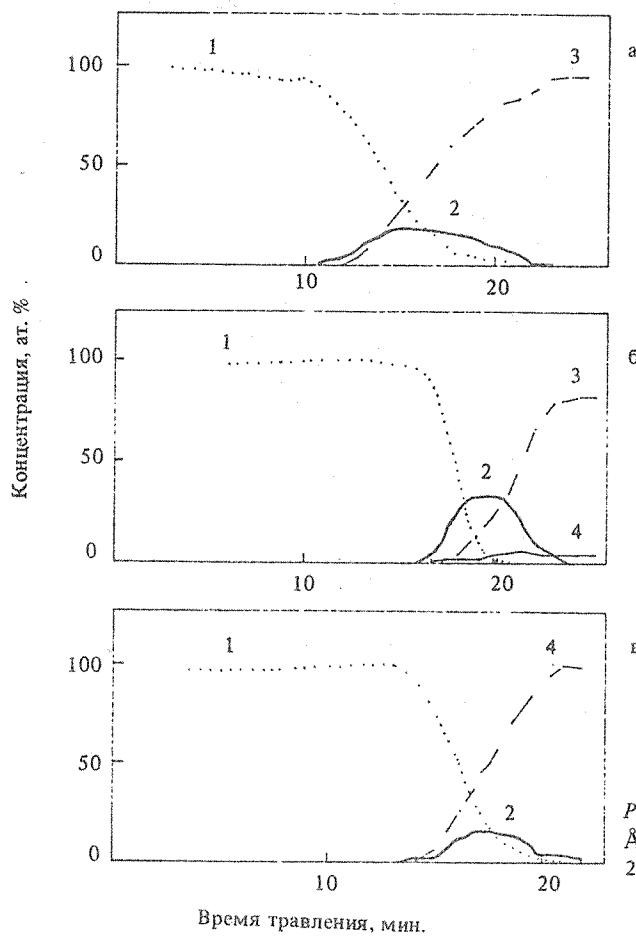
Рис. 1. Результаты профильного анализа пленок a-Si : H (1000 Å) на подложках: а)  $In_2O_3$ ; б) ITO; в)  $SnO_2$ . 1 - Si; 2 -  $SiO_2$ ; 3 -  $In_2O_3$ ; 4 -  $SnO_2$ .
