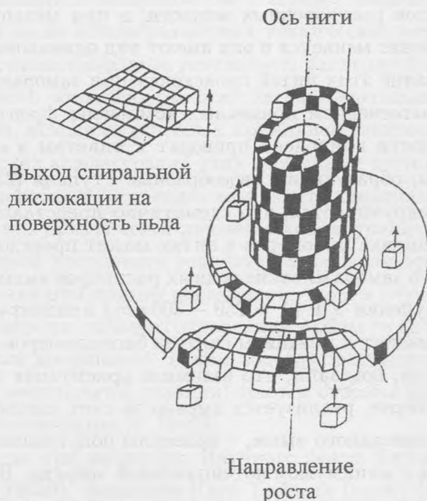
Рис. 4. Схема роста спиралевидной структуры.
