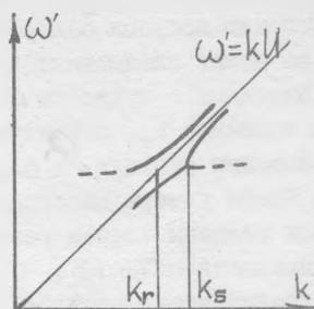
Р и с. 1. Спектр продольных волн в пучково-плазменной системе в бездиссипативном случае. Пунктирная линия отвечает плазменным колебаниям
