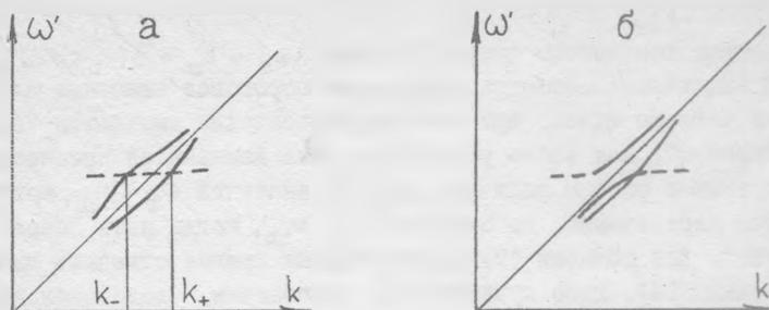
Р и с. 2. Спектры продольных волн в пучково-плазменной системе в случаях а) сравнительно сильной диссипации  $\omega_b \ll \omega_{th}$ , б) сравнительно слабой диссипации  $\omega_b \gg \omega_{th}$
