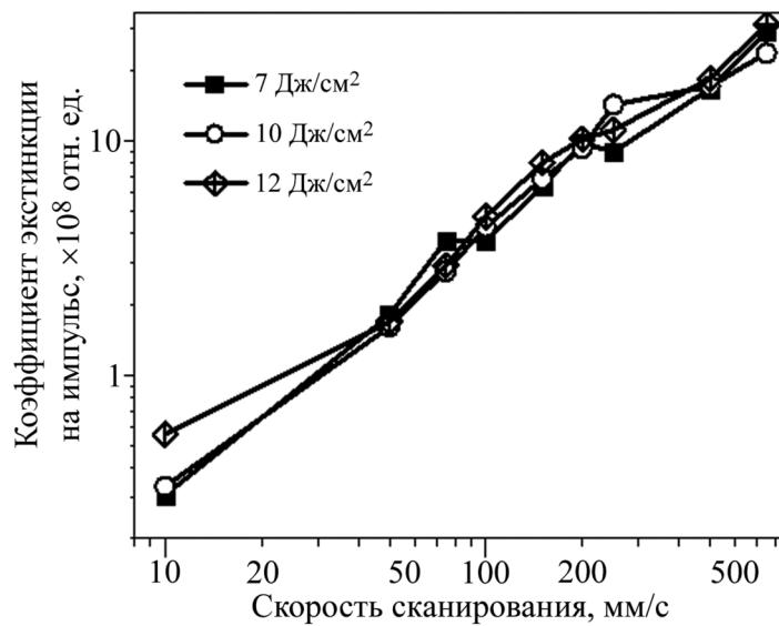
Рис. 3: Зависимость коэффициента экстинкции на импульс от скорости сканирования (оси представлены в десятичных логарифмах).
