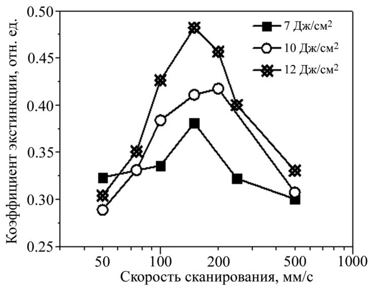
Рис. 2: Коэффициент экстинкции коллоидных растворов НЧ в зависимости от скорости сканирования лазера для различных плотностей энергии.
