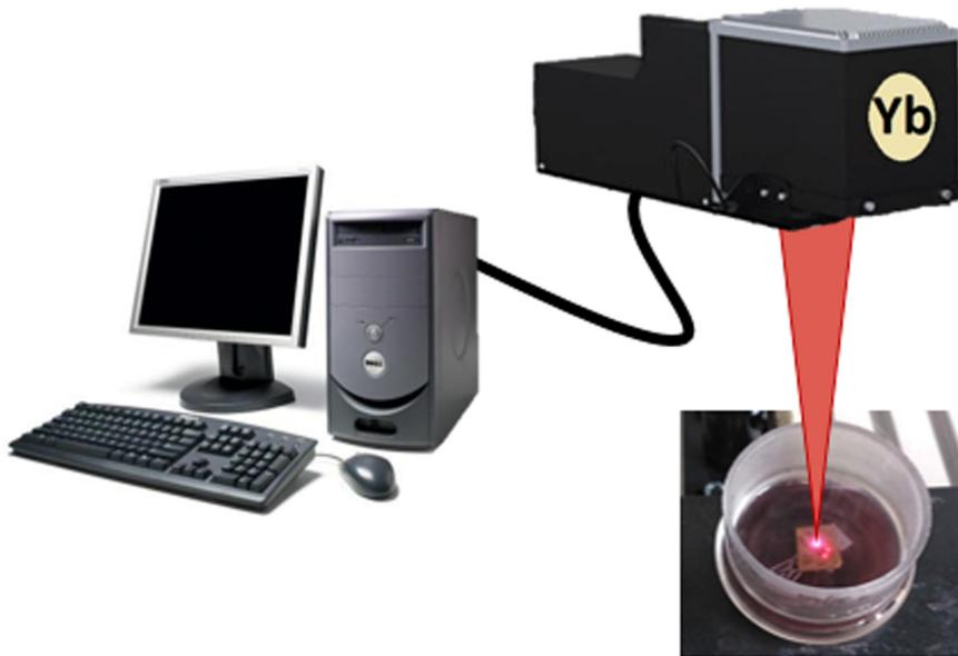
Рис. 1: Схема эксперимента для наработки наночастиц кремния методом лазерной абляции.
