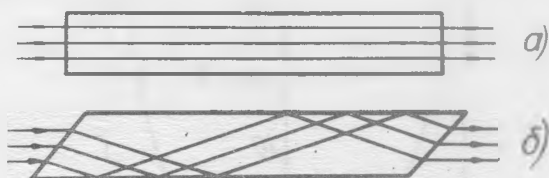
Р и с. 1. Прохождение усиливаемого излучения через активный элемент: а) прямой ход лучей, б) схема с отражениями от боковых поверхностей
