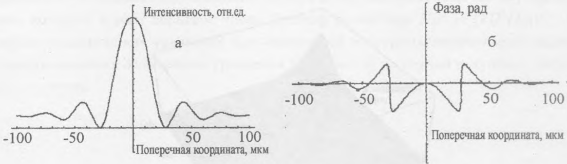
Рис. 2. а) Распределение интенсивности солитона с “чирпом”. Масштаб по оси x в микро-нах. б) Распределение фазы.
