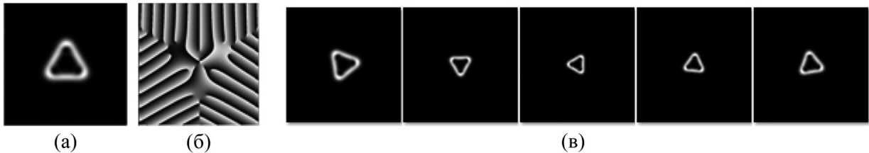
Рис. 1: Интенсивность (а) и фаза (б) СП. Теоретически рассчитанные распределения интенсивности СП в различных сечениях (в). На (б) изменение цвета от белого до черного соответствует изменению фазы от 0 до 2\pi .
