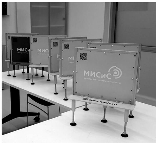
Рис. 1: Эмульсионные детекторы, готовые для установки на объекте.
