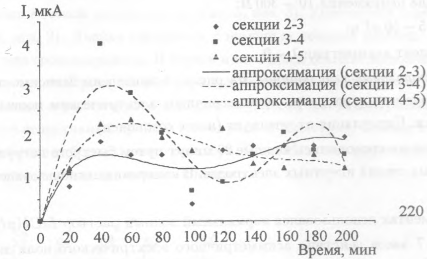
Рис. 7. Ток, индуцируемый при наложении асимметричного электрического поля ( E^+ = 2 \text{ В/см} ; \nu = 40 \text{ кГц} ; коэффициент асимметрии 0.75; аппроксимация полиномом 5-й степени).
