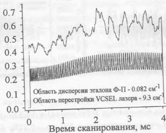
Рис. 3. Спектр поглощения NO_2 в области 660 нм, записанный с использованием VCSEL диодного лазера.
