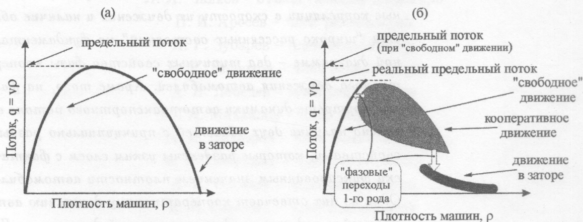
Рис. 1. Фундаментальная диаграмма и фазовые состояния автотранспортного потока. (а) – модель Лайтхилла–Уизема, (б) – диаграмма с областью широко рассеянных состояний.
