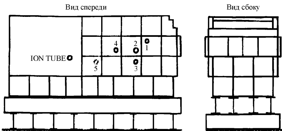
Рис. 1: Нейтронный спектрометр по времени замедления нейтронов в свинце СВЗ-100. Цифрами обозначены измерительные каналы.
