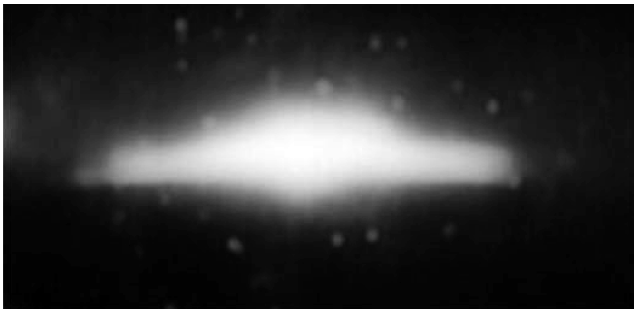
Рис. 5: Фотография объёмного разряда, реализованного в лабораторной установке под действием кавитации на плоских электродах.
