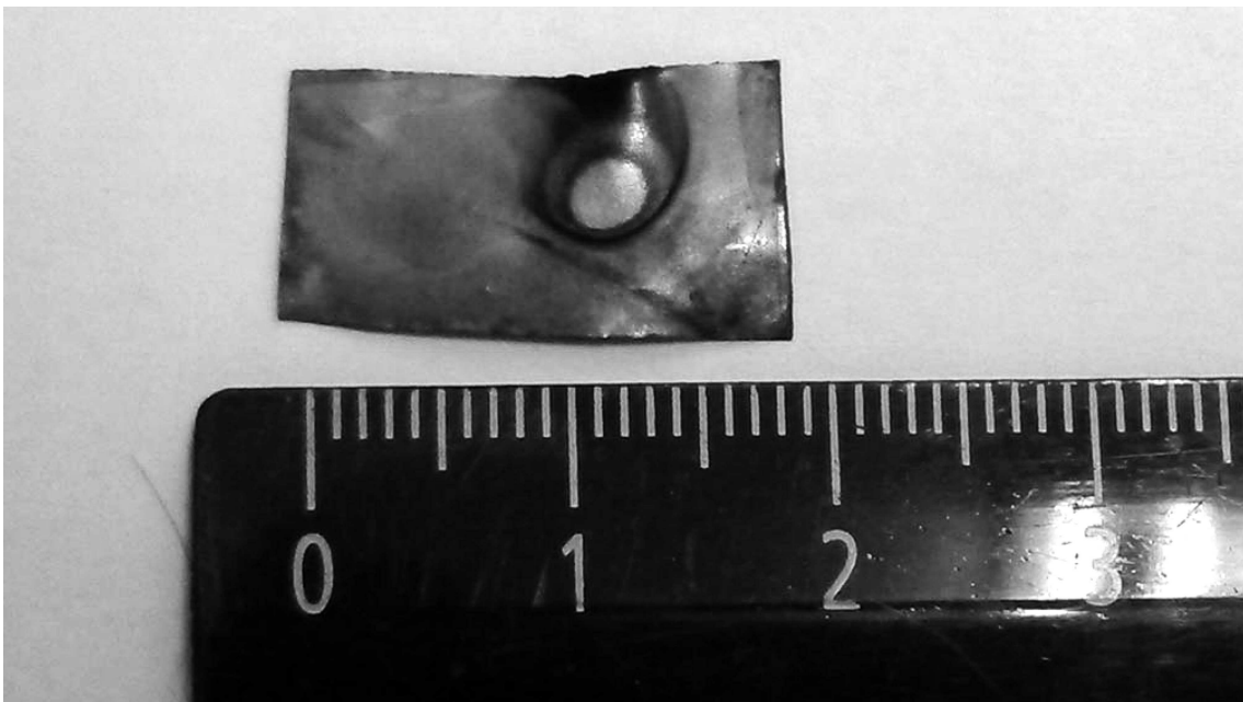
Рис. 5: Фотография мишени Pd/PdO:D_x после облучения пучком D^+ (светлое пятно в центре соответствует области с повышенной плотностью тока).
