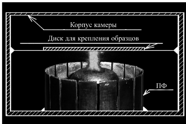
Рис. 2: Фотографии ПФ в видимом свете (самосвечение), снятые с помощью ЭОП (экспозиция 3 нс) и осциллограмма производной тока. Стрелка – момент максимального сжатия пинча.
