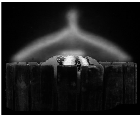
Рис. 9: Кумулятивный поток, получаемый с анодной вставкой, показанной на рис. 8.
