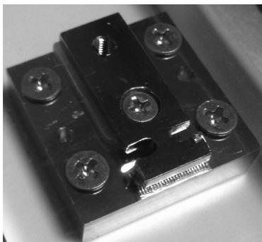
Рис. 1: Фотография непрерывной лазерной диодной линейки (ЛДЛ) мощностью 60 Вт, излучающей в спектральном диапазоне 808 нм, собранной в корпусе типа C-S маунт.
