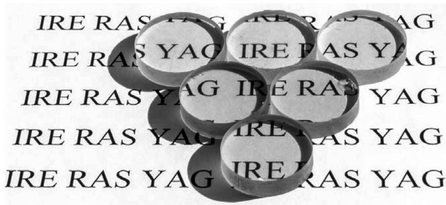
Рис. 1: Общий вид керамик группы "2". Диаметр образцов равен 21 мм.
