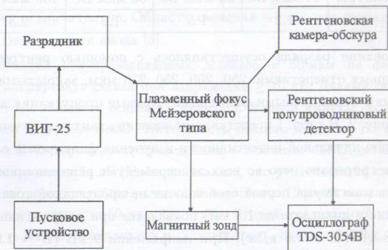
Рис. 1. Блок-схема установки плазменный фокус с диагностическим комплексом.
