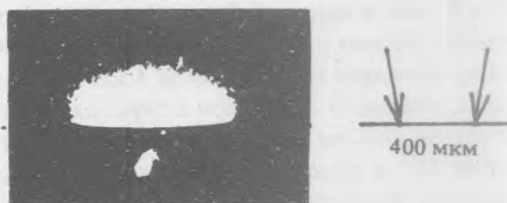
Рис. 2. Рентгеновская обскурোগрама, зарегистрированная за алюминиевым фильтром толщиной 3 мкм под углом 90^\circ к направлению движения лавсановой пленки толщиной 6 мкм, нагреваемой излучением с плотностью потока 4,8 \cdot 10^{12} Вт/см 2 при длительности импульса 8 нс.
