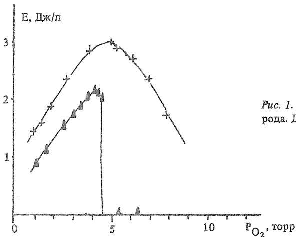
Рис. 1. Зависимость удельного энергосъема от давления кислорода. Диаметр барботера 150 мм (+), 100 мм (▲).
