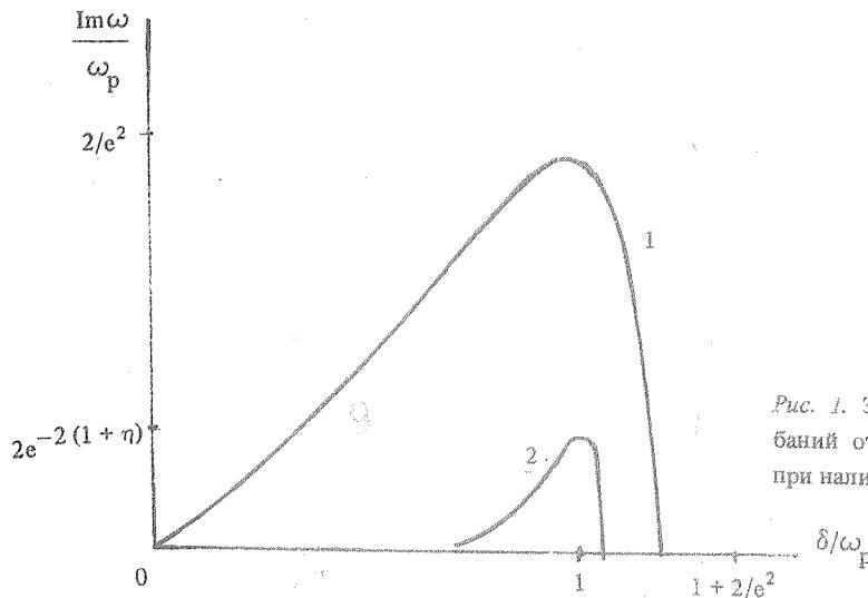
Рис. 1. Зависимость инкремента нарастания колебаний от параметра  $\delta$  в отсутствие зазора (1) и при наличии зазора (2).
