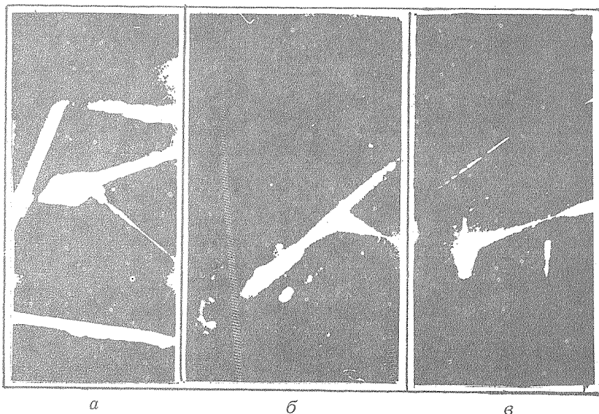
Р и с. 3. Фотографии треков восстанавливающего плоского и восстановленного фокусированного волноводных пучков, взаимодействующих на ДР, записанных с помощью цилиндрической (а), сферической (б), конусоидальной (в) объектных волн
