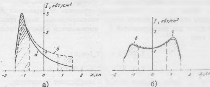
Р и с. 2. Распределение интенсивности излучения непрерывного НГ-лазера в плоскости выходного зеркала ( $z = 1$ ) для каждой из схем, представленных на рис. I (заштриховано выходящее излучение)
