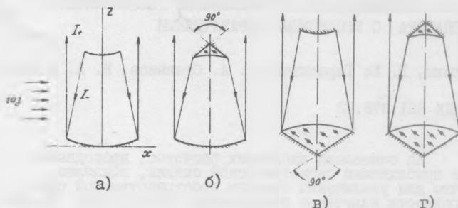
Рис. I. Упрощенные схемы обычного (а) и призменных (б-г) телескопических резонаторов
