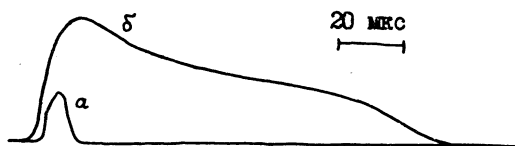
Р и с. 1. Типичный сигнал генерации (а) и световой импульс накачки (б)
