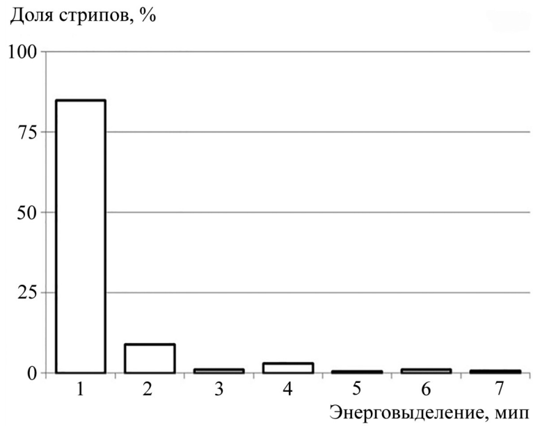
Рис. 3: Распределение средних фоновых энерговыведений в одиночных стрипах, в процентах от общего числа сработавших стрипов.
