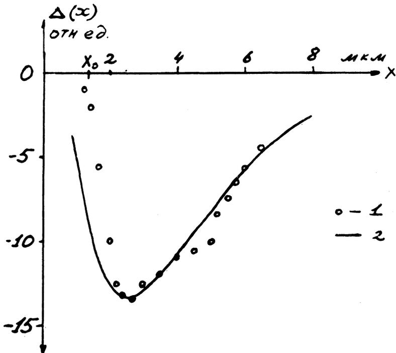
Р и с. 2. Деформация контуров свечения кристаллов ZnS-C1 под действием переменного поля: 1 -  $\Delta_{\text{эксц}}(x)$ , 2 -  $-\Delta_{\text{геор}}(x)$ . ( $\alpha_0 = 0,6$ ,  $x_0 = 1,3 \cdot 10^{-4}$  см,  $D = 0,85$  см<sup>2</sup>/сек,  $\omega/2\pi = 3$  кгц,  $E_0 = 100$  в/см).
