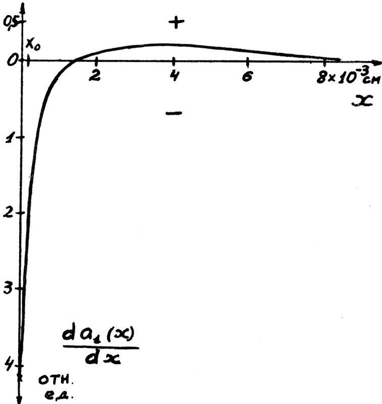
Р и с. 1. График функции  $da_1(x)/dx$ , вычисленный при  $\alpha_0 = 0,6$ ,  $x_0 = 1,3 \cdot 10^{-4}$  см,  $D = 0,85$  см<sup>2</sup>/сек,  $\omega/2\pi = 3$  кгц.
