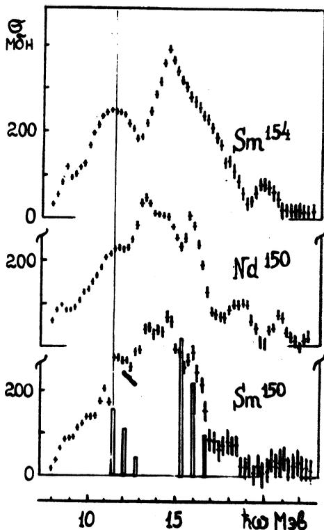
Сечения фотопоглощения на  $\text{Sm}^{150}$  (слабо деформированное ядро  $N = 88$ ),  $\text{Nd}^{150}$  и  $\text{Sm}^{154}$  (сильно деформированные ядра  $N = 90$  и  $N = 92$ ), измеренные в работе<sup>10</sup>. Видно (это отмечено вертикальной линией на чертеже), что у слабо деформированного ядра  $\text{Sm}^{150}$  в сечении фотопоглощения наблюдается пик при той же энергии, при которой наблюдается продольный максимум гигантского резонанса в ядрах сильно деформированных.
