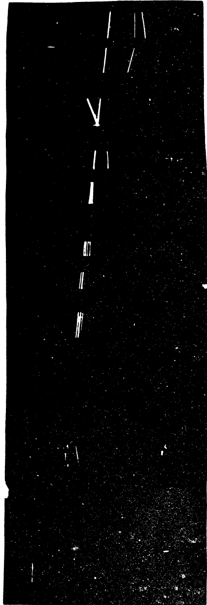
Р и с. 2. Типичный случай взаимодействия заряженного адрона.
