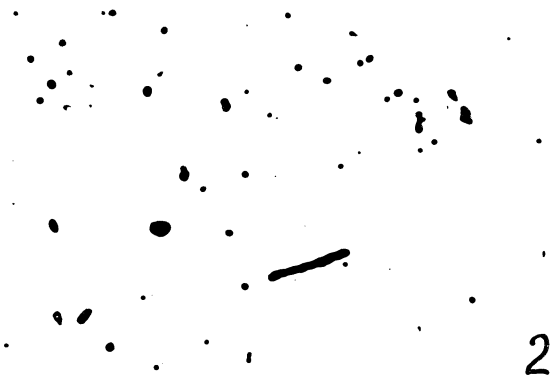
Р и с. 1. Микрофотографии следов дейтронов с энергией 700 кэв в поверхностных слоях эмульсии T_3 . 1. Эмульсия проявлена обычным способом с использованием амидолового проявителя. 2. Эмульсия по методу, описанному в статье
