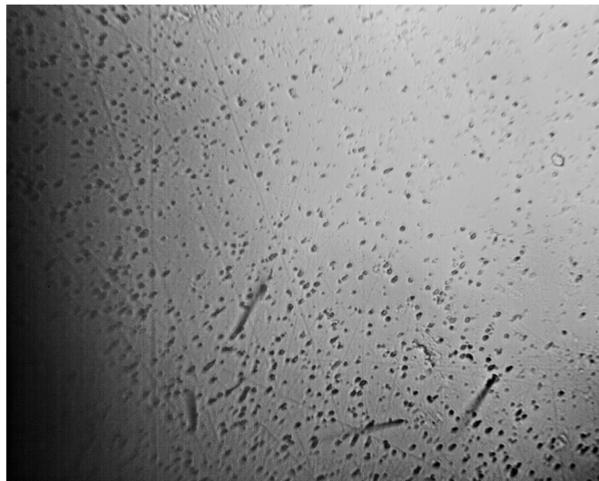
Рис. 3: Фрагмент микрофотографии поверхности кристалла M-L-11-10 из палласита Марьялазти с высоким градиентом плотности треков ядер железа. Размер изображения 284 \times 226 мкм.
