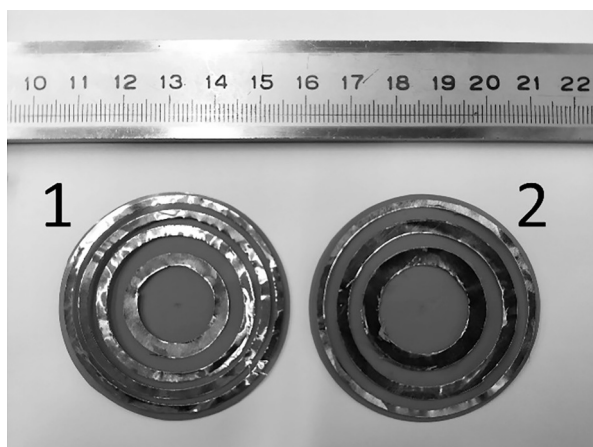
Рис. 3: Зонные пластинки для частот 800 ГГц (1) и 600 ГГц (2).
