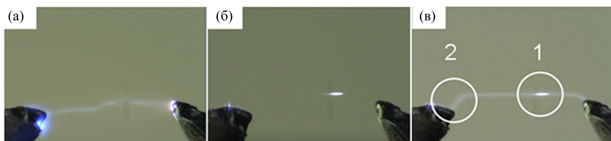
Рис. 4: (а) распространение электрической дуги без ЛИПК; (б) ЛИПК; (в) ЭДР в присутствии ЛИПК, область 1 – ЛИПК, 2 – сток дуги.
