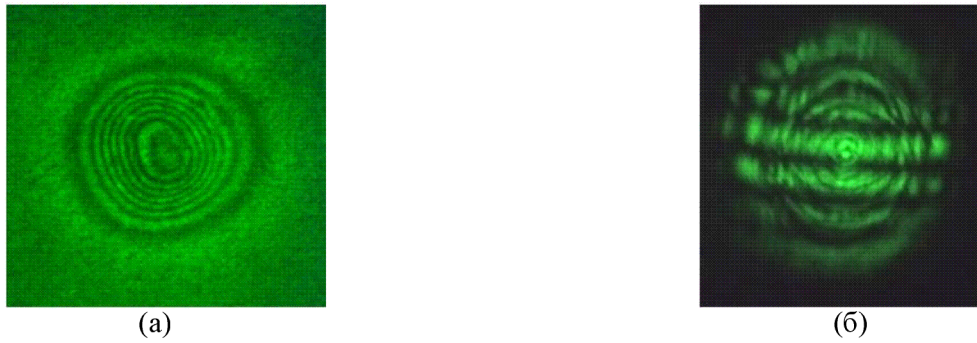
Рис. 6: (а) Микрофотография фазовой структуры, сформированной узким ( w = 7 мкм) пучком TEM_{01} . (б) Аберрационная картина в дальней зоне после охлаждения НЖКП; угловое расстояние между полосами \delta\theta = 0.05 .
