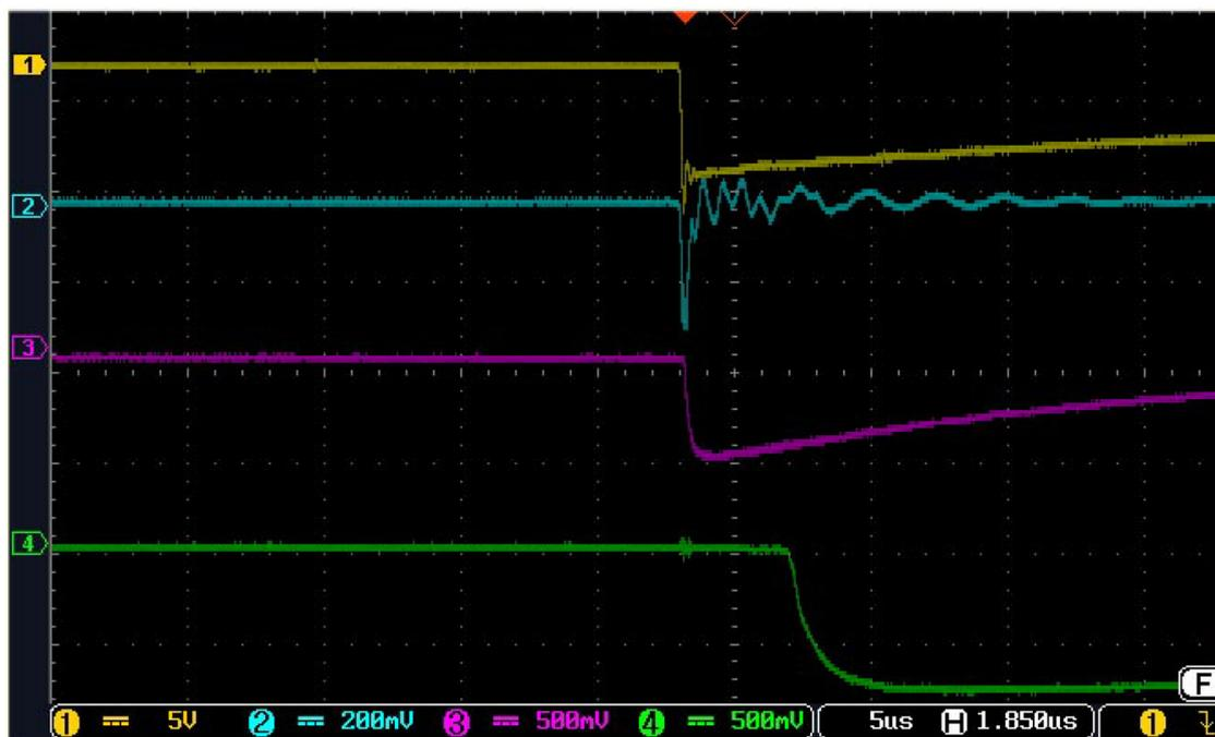
Рис. 2: Осциллограмма измерения скорости распространения фронта ионизации скользящего разряда при  $P = 40$  Торр,  $U = 7$  кВ,  $I = 170$  мА. 1 — напряжение; 2 — ток; 3 — сигнал с первого фотоприемника Ф1; 4 — сигнал со второго фотоприемника Ф2.
