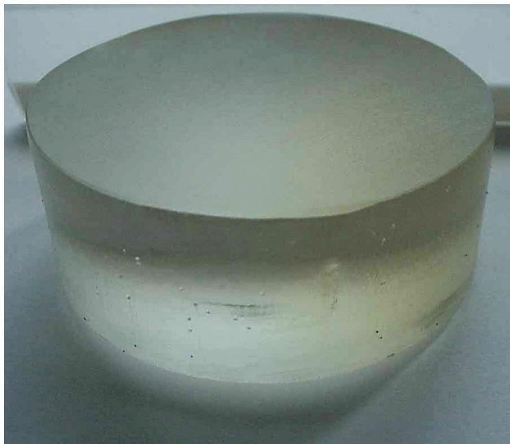
Рис. 1: Монокристаллический диск диаметром 65 мм и толщиной 30 мм при освещении дневным светом.
