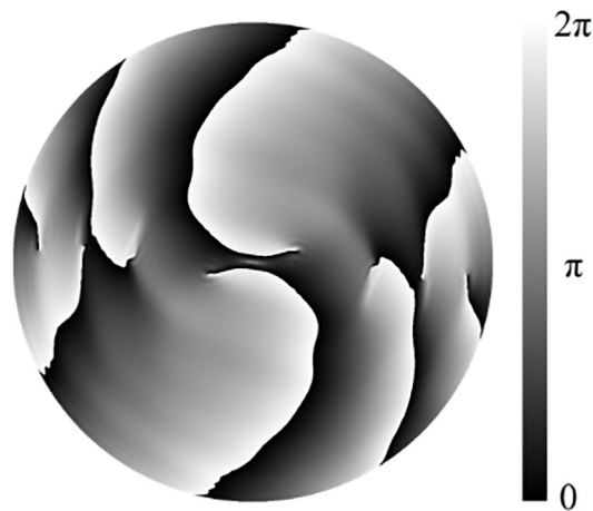
Рис. 2: Используемая для формирования двухлепесткового поля фазовая маска в градациях серого, черный цвет соответствует фазе 0, белый – 2\pi , разрешение 1024 \times 1024 пикселя, физический размер при реализации на ПВМС Holoeye Pluto NIR 8.192 мм.
