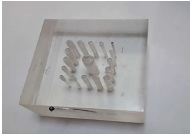
Рис. 1: Фотография тест-фантома в форме параллелепипеда из ПММА размером 150 \times 150 \times 40 мм 3 . Фантом имеет сквозные отверстия в количестве 17 штук с вариабельными размерами от 1 до 6 мм.
