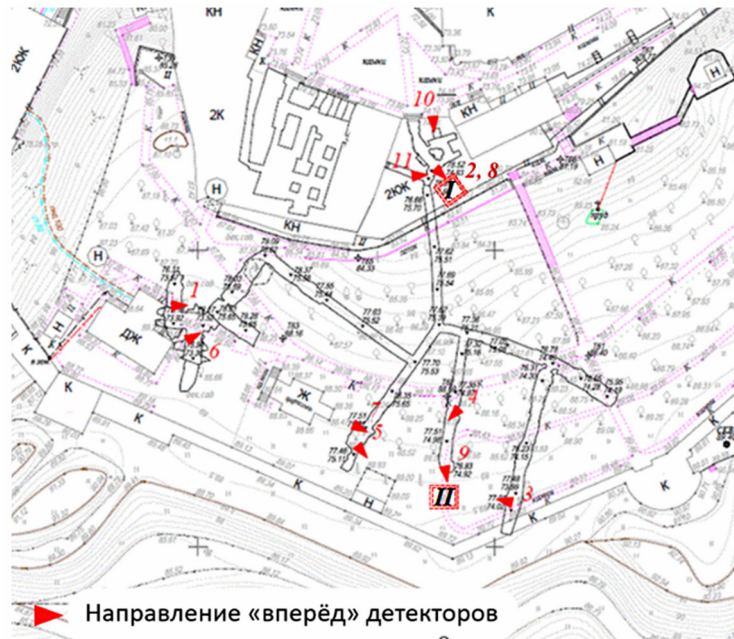
Рис. 3: Схема расположения детекторов в пещерах Свято-Успенского Псково-Печерского монастыря. Красными треугольниками обозначено положение детекторов, номера детекторов – красные цифры от 1 до 11. Острые концы треугольников указывают направление обзора для исследования объектов. Два квадрата на рисунке, обозначенные цифрами I и II, показывают области исследуемых объектов. Буквами К, Н, ДЖ и др. геодезистами на топографической схеме обозначены монастырские строения; серыми цифрами обозначены уровни высоты местности над уровнем моря.
