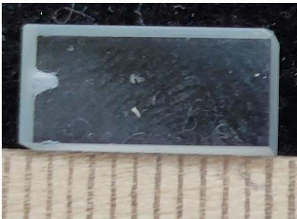
Рис. 2: Образец кварцевого стекла КУ-2 размером  $10 \times 5 \times 4 \text{ мм}^3$ , подготовленный для облучения.
