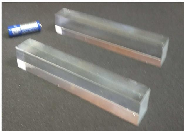
Рис. 2: Фотография кристаллических модулей  $BaF_2$ .
