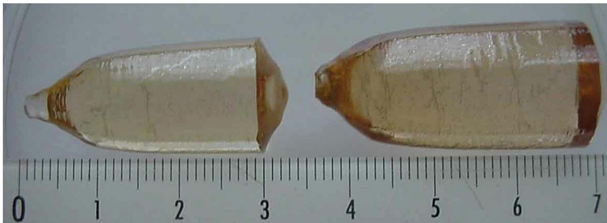
Рис. 1: Кристаллы  $YAG:Yb:Mg$  (a) и  $YAG:Yb:Ca:Mg$  (b).
