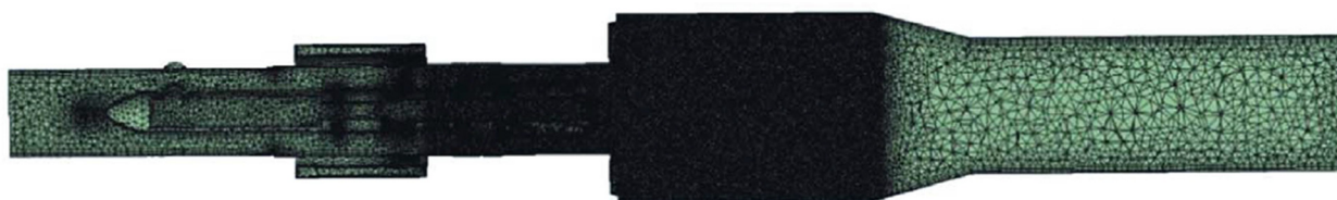
Рис. 2: Дискретная (сеточная) модель камеры сгорания.
