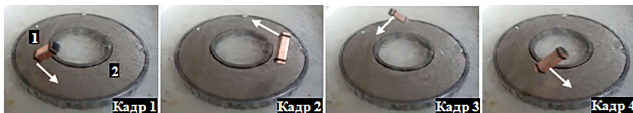
Рис. 6: Вращение ВТСП-носителя (1) в исходном наклонном положении над кольцевой системой РМГ-1 (2) демонстрирует сохранение его пространственной ориентации в процессе движения (кадры 1 и 4 – начало и конец одного оборота).
