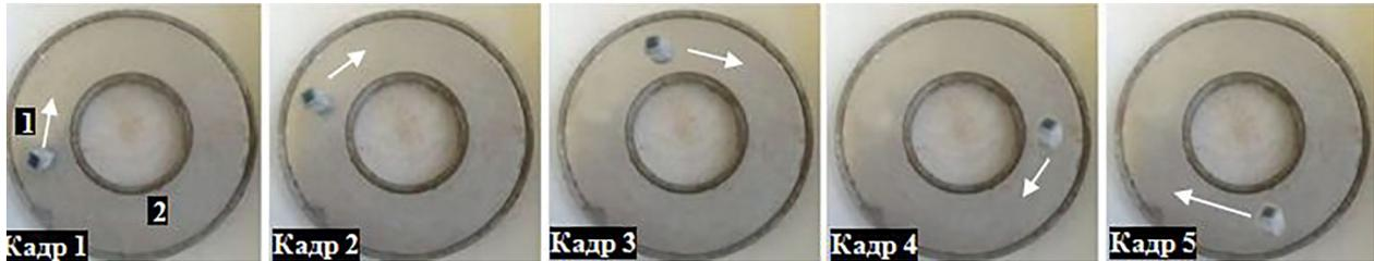
Рис. 4: Вертикальное положение ВТСП-носителя (1) над кольцевой системой РМГ-1 (2) с внешним диаметром  $2R_{out} = 105$  мм и внутренним диаметром  $2R_{inn} = 45$  мм, поле на поверхности магнита  $B_{max} = 0.35$  Тл.
