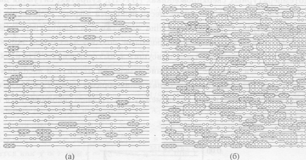
Рис. 2. Кластеры кислородных ионов в цепочках, формирующие конечные кластеры NUC, для случайного распределения (а) – \delta = 0.3 и (б) – \delta = 0.6 . Открытые кружки – ионы кислорода в цепочках, формирующие NUC; обведены кислородные кластеры.
