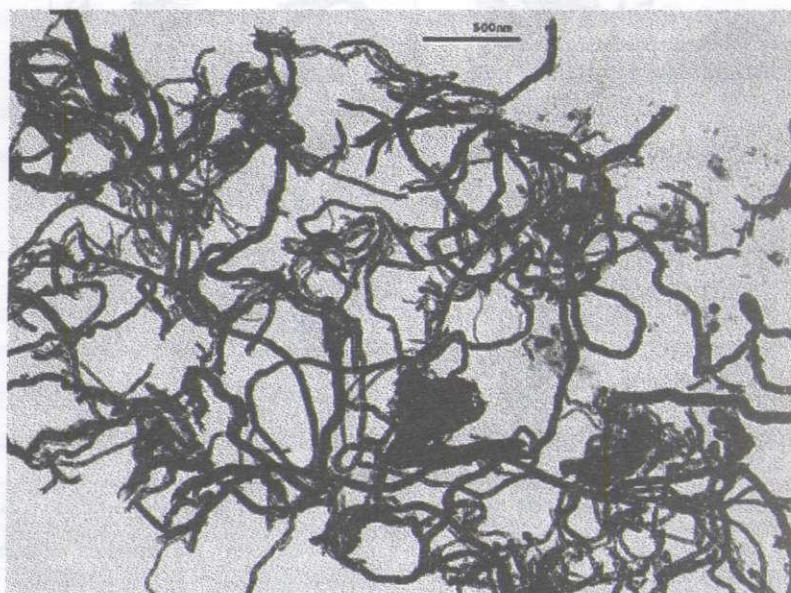
Рис. 1. Изображение углеродных нановолокон, полученное с помощью просвечивающей электронной микроскопии.
